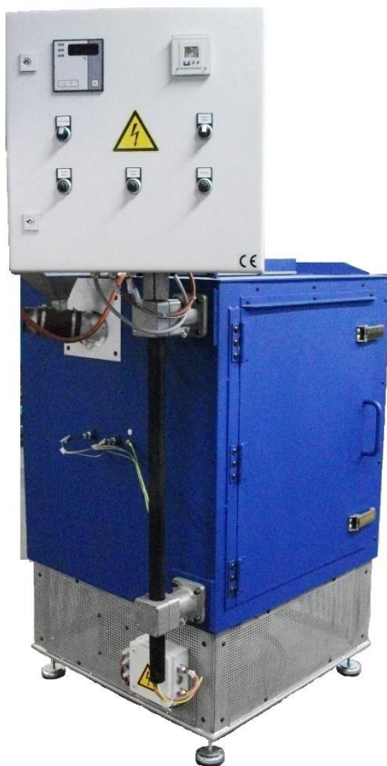
Isometrische Ansicht des Trockners
